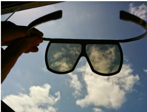
Ilustración 3 La luz solar (no polarizada) atraviesa dos filtros polarizadores lineales (o un filtro vertical, o un filtro horizontal). La intensidad de la luz disminuye y no depende de la dirección del filtro. Para un filtro ideal la intensidad disminuye factor 2, I_{out} = \frac{1}{2} I_{in} .
